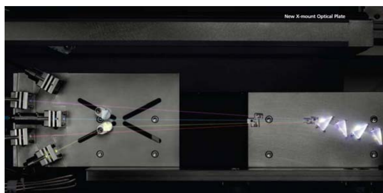
圖 1-9、光信號激發系統光學通路
